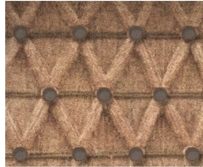
Gevlochten riet met uitstekende gasleidingen
